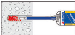
4a. Gereinigtes Bohrloch vom Grund auffüllen
